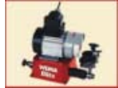
Schärfmaschine für Standard-Kopierdrehstähle (Spitzstähle), Typ BLITZ.
