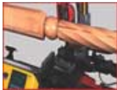
Fräsaggregat mit senkrecht eingestelltem Fräs- kopf
